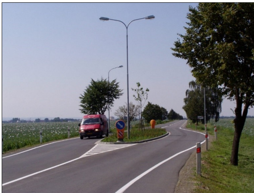
Obrázek 11 Oboustranně vychýlený ostrůvek na vjezdu do obce (Bedihošť), zdroj: CDV
