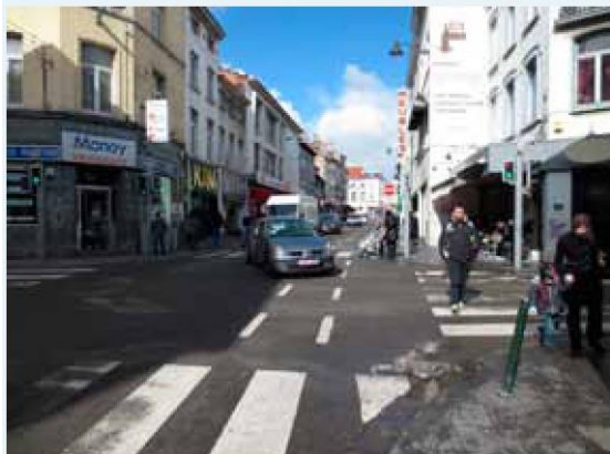
Obrázek 25 - nehoda na křižovatce mezi silnicí Gand a ulicí rue de l'Ecole: vozidlo odbočuje vlevo a narazí do cyklisty, který jede stále rovně. Na cyklostezce lze použít červený nátěr k označení místa křížení pohybu.
