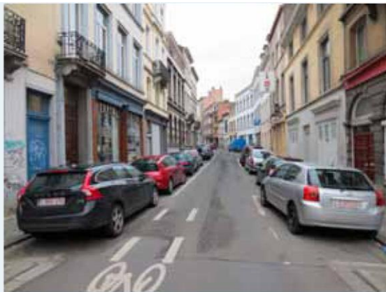
Obrázek 32: nehoda na ulici rue de la Tulipe: křížení cyklisty a vozidla není v této cykloobousměrce snadné. Poznámka: přítomnost dvou parkovacích pruhů snižuje šířku průjezdu na méně než 4 m, což brání řádnému zásahu záchranné služby.
