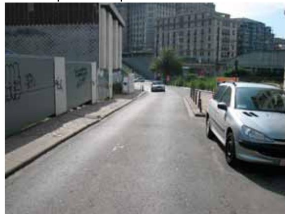
Obrázek 40 - ulice Jacques de Lalaing: parkování bylo zakázáno v délce 14 metrů směrem ke křižovatce. To umožňuje cyklistům lepší umístění na silnici před příjezdem ke křižovatce a také lepší přehled o provozu na, který přichází na křižující komunikaci.
